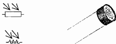
Slika 10.1. Simboli i primjer izvedbe fotootpornika
